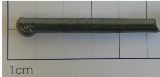
Abbildung 11: Bild des  $\text{TbMnO}_3$ -Einkristalls nach der Zucht
