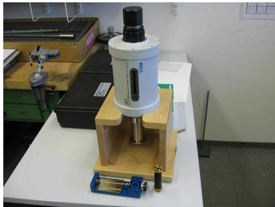
Abbildung 17: Komponenten der VSM-Option: Motor, Probenstab und Puck
